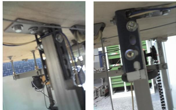
1. 中間腳固定機構：以大型 L 型鐵材和角鋼做結合，用螺絲穿過中間腳鋁條，讓中間腳能活動 90 度的動作。
