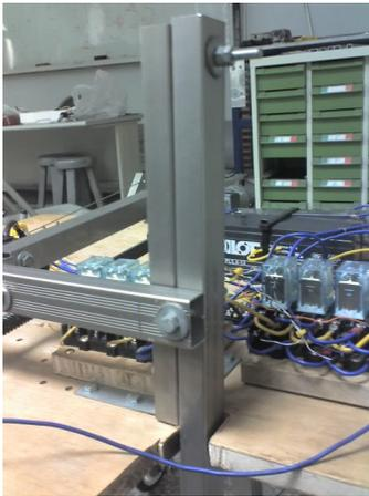
3. 本體與前腳結合機構：鋁條以站立方式固定於本體，用螺絲穿過前腳鋁條與固定鋁條，使前腳能活動達 180 度。
