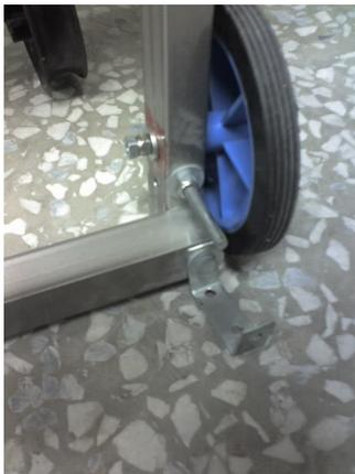
4. 舉重機構：我們分別在前腳底部的左右邊裝了 L 型鐵，彎成類似鉤子形狀，達到舉重功能，螺絲是為了防止啞鈴掉落而裝設。
