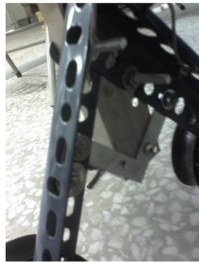
3. 中間腳輪子固定機構：用角鋼和方角鐵及鋁條結合成 Y 字型，其目的是為了當前或後腳舉起時，中間腳承受的力比較穩固而使用。
