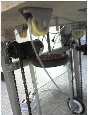
4. 中間腳舉起機構：也是採用鋼索拉取，拉取方式與後腳相同，其中比較不同的是以一顆馬達來使左右中間腳達到舉起的功能。
