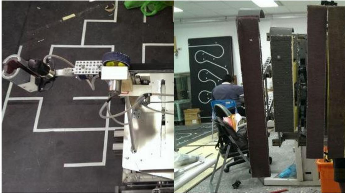
說明：在伸縮吊臂機構的上方裝有一顆直流馬達，讓機構達到伸縮的效果。
