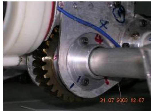
圖（五）底盤轉臂蝸輪蝸桿組
