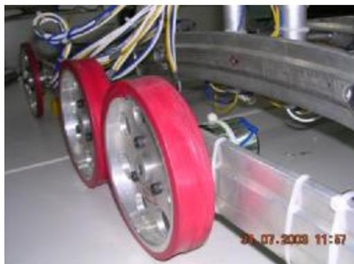
圖（八）抓地力強的動力輪設計
