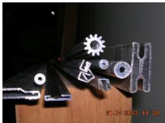
圖（十）各種不同斷面形狀的鋁擠型
