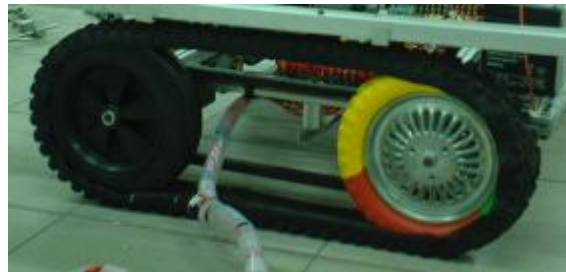
圖三 車輪加裝履帶
