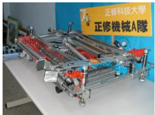
圖(二) 機器人全縮整體圖,總高度低於 30cm
