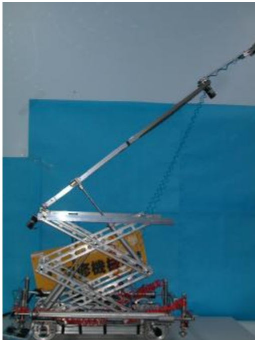
機器人全伸整體圖，最高高度可達到 200cm 之高
