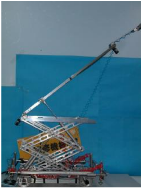
圖(三) 機器人全伸整體圖，最高高度可達到 200cm 之高
