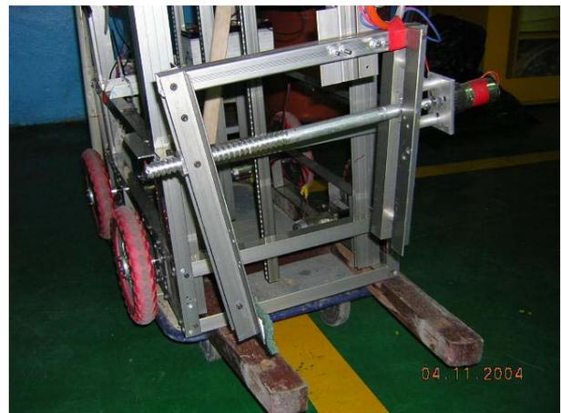
(圖五)爪子機構圖
