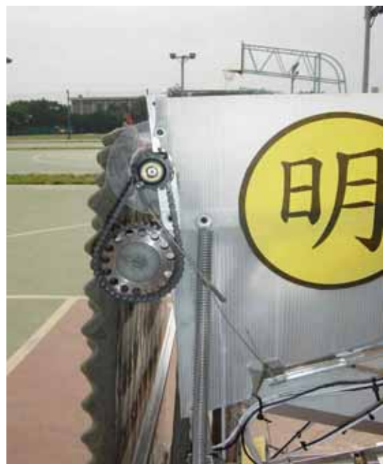
圖4 1:4 鏈齒輪圖(第二道防止卡球機構)
