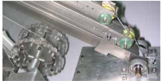
圖 5. 收線器與滑輪組結構
