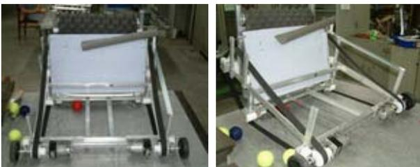
收球機構主要的功能大量取球，並且球載機構中能順利收到球箱，不打滑或收不起來等，因此，吸音棉與貝版間的距離以及吸音棉繃緊的程度就是以實驗來取得最佳化了。
