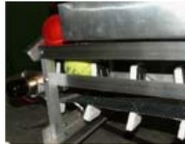
球類辨識可以帶來很大的便利性，也能省略因人為而產生的疏忽。原理是利用sensor因不同顏色反射出不同的波長感應出不同的電壓大小，再利用SVR靈敏電阻作電壓值大小的微調，調整完畢後，利用程式作3取2的判別，在利用繼電器作電源的切換，即可作出判別球種的動作了。
