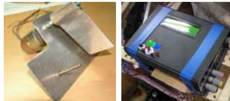
機器手臂的優點是送球準確，可避免被對手干擾阻擋，好處不少，但缺點是重量也很可觀，再者，當我們加壓的時候，必須注意馬達心軸是否能承受，所以心軸鑽孔的時候要盡量鑽在中心不位，固鎖的螺絲直徑不宜超過3mm。在比賽前也因該要多加工幾顆馬達，在馬達心軸斷裂
