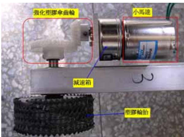
圖 1-2、車身底盤的動力傳動部分之設計
