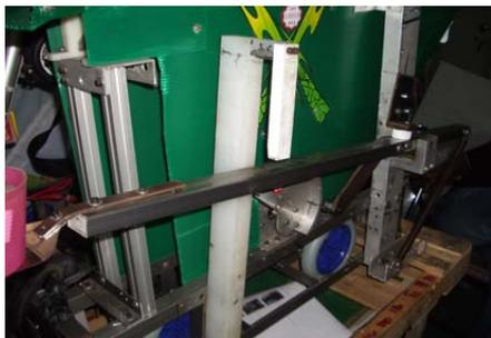
圖七(d) 投球臂沿軌道上下運動
