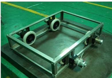
(圖一)四輪傳動底盤
