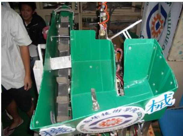
(圖五) 儲球箱及攪拌器
