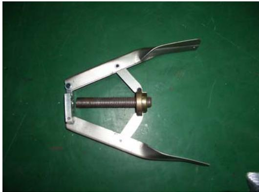
(圖四)取球用夾爪機構
