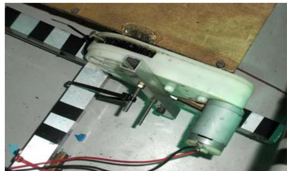
圖七(投球機的馬達 24V)
