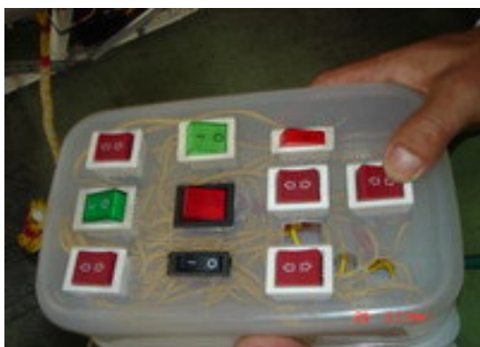
圖二十五 控制象鼻管上下的開關
