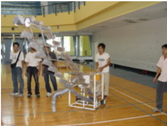
圖一車身離地面盡量貼近地面避免送球時造成晃動
