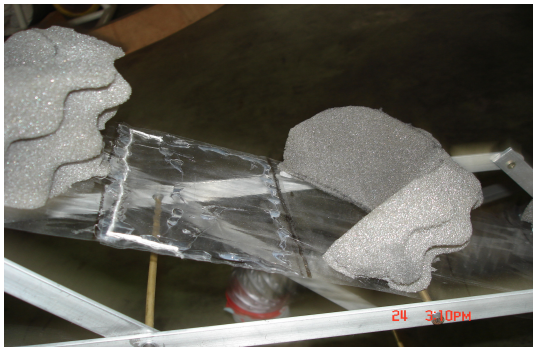
圖十六 超薄透明塑膠帆布頭尾縫合
