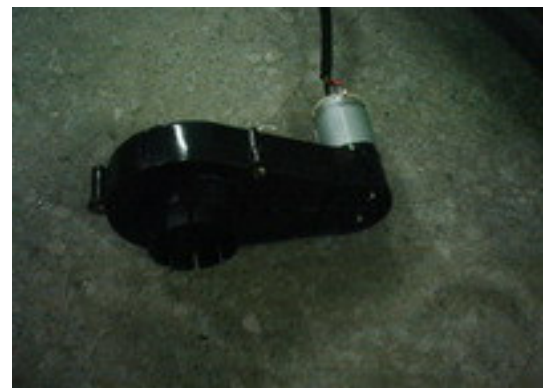
圖七 採用吉普車傳動馬達
