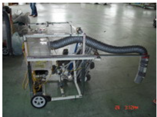
圖二十八 全都採用直流電源捨棄氣壓
