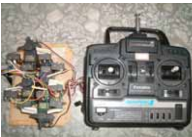
此圖為伺服馬達遙控器及其電路
