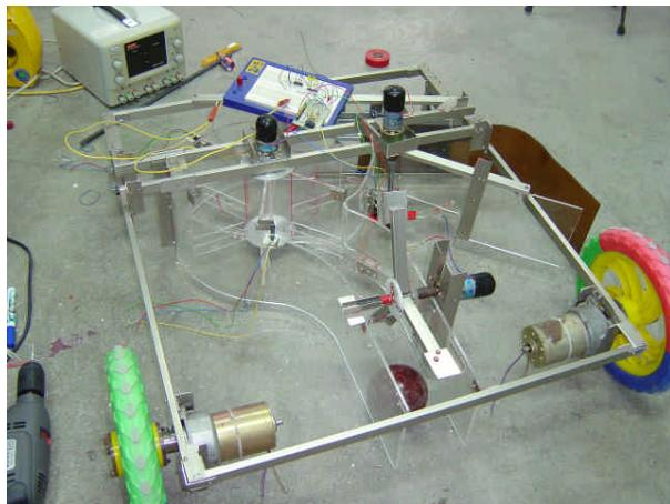
圖八 將所有機構架上車體以電源供應器測試
