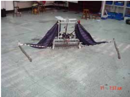
(圖十二) 兩段式防守手臂機構展開後
