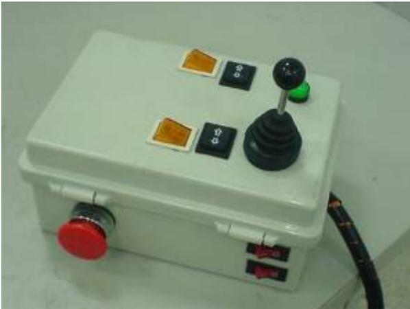
電控是最主要的環節，若只有機構缺乏電控也是徒勞無功，不僅馬達以及氣壓也須電來做控制，我們為講求為簡單容易維修我們採用繼電器控制，在電源方面我們採用兩顆 12V 5 安培的電池串聯，由於我們機構重所以馬達的負載甚大，固選用的電池安培也跟著增加，將電池串聯變為 24V 使馬達轉數提高使我們快速移動到目的地。
