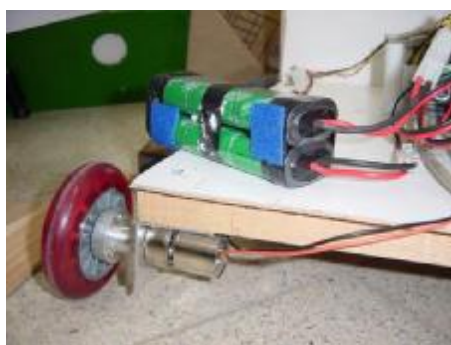
圖三、以直流馬達驅動自走車車輪
