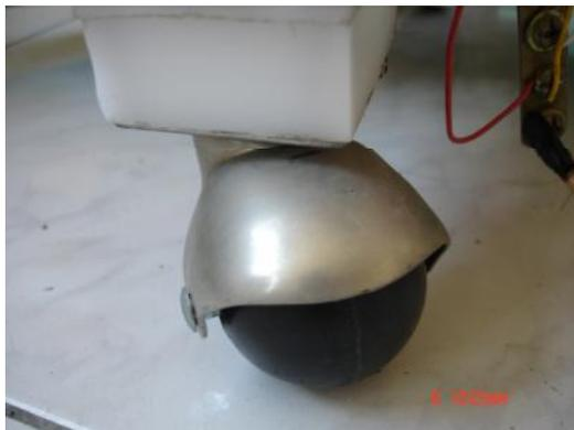
轉向輪：辦公室坐椅之惰輪遇到近乎 90 度彎角時，會照成一個鎖死的力，照成轉彎時的不順暢及卡死。經討論後使用含滾珠之圓球惰輪，方便轉彎行走時也順暢許多。
