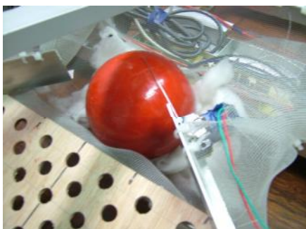
圖 15：收球機構之感測器及木球
