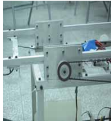
圖五 取球機構利用時規輪何時規皮帶帶動
