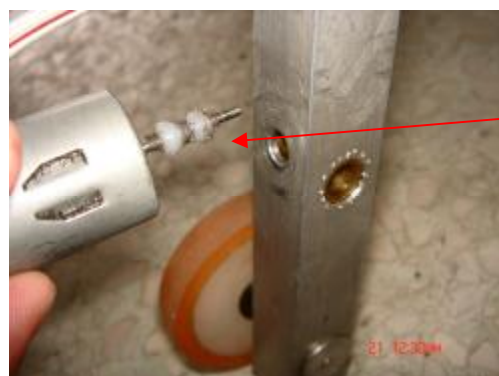
U型接觸面使軸心左右移動
