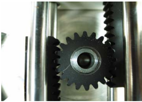
圖七 夾腳器內部齒輪
