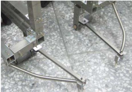
除了利用兩個後輪不同轉速達成轉彎外，在本體的最前方，用了兩根能隨著軌道一起轉向的支撐物。其最底下有突出的螺絲桿，在轉彎時能隨著軌道的形狀而擺到轉彎後的軌道上，用來支撐本體可能會出軌的前輪，使整台機器不會因只有後輪兩點碰到軌道而掉下。而平常行進時，會由彈簧拉回起始之平行軌道狀況。
