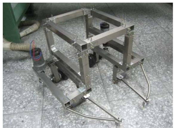
如上圖所示，此部分為我們機器人過關的重點部分。若連同手臂高度來算，本體的四個輪子所在高度為，從手臂底部算起高 55CM 處的第三層高度，利用一開始就已經固定好的高度，完成登桿。本體中間空出高 32CM x 寬 20CM 的空洞，目的為輕鬆度過每個支撐鐵管而凸出 5CM 的方管，至於高度要拉到 32CM 高，則是為了也能夠在不加控制的狀況下度過最高的那根 30CM 方柱。
