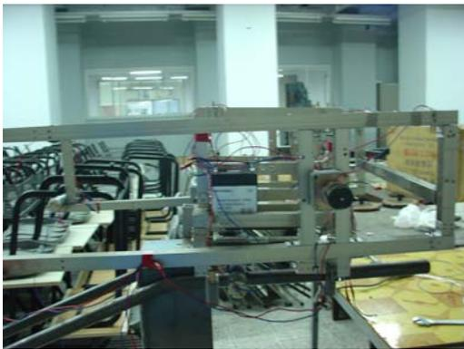
手臂總長 95CM，與主機相連的馬達位於離第 70CM 高之處。最底部的輪子，用來從出發區移動到軌道前面用的。位於 25CM 高之處還有一層可以水平移動 5CM 之第二層輪子，用來在 30CM 垂直軌道落差時，可以直接用這層輪子銜接上較低層之軌道，省去控制之麻煩。此層輪子靠近時的輪距為 23CM，還沒用到此層輪子時，則可以向後伸縮至 28CM，以避免在旋轉手臂時撞到軌道。
