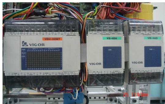
圖十二 PLC 主機、DA 轉換器與 AD 轉換器
