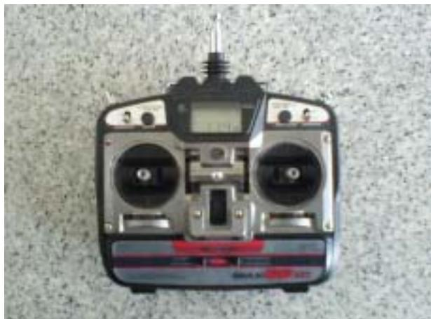
圖十一 無線遙控發射器
