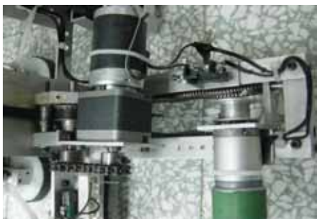
(圖三) 左右夾持機構
