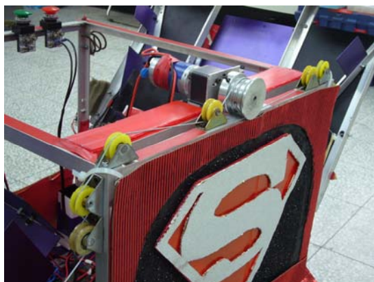
圖四、放下手臂的馬達與鋼索。
