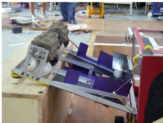
圖三、機器至取球區機構。
