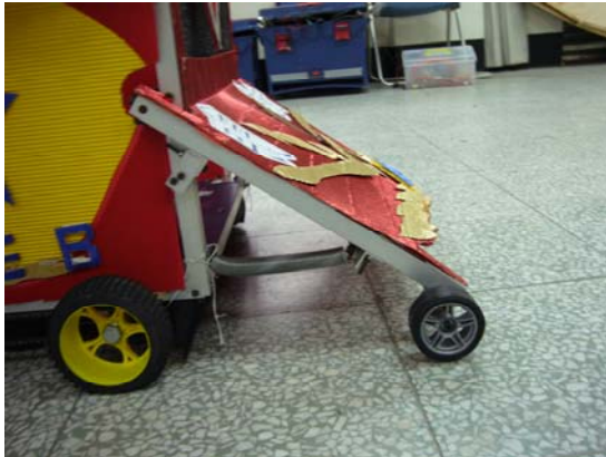
圖七、車前的緩衝裝置。
