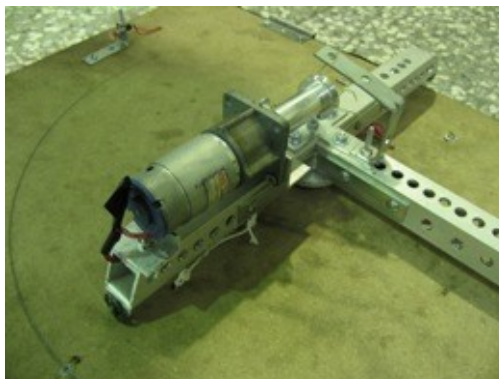
圖 7 取球機構—捲線器馬達
