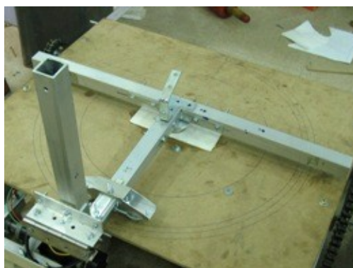
圖 5 取球機構—支撐架
