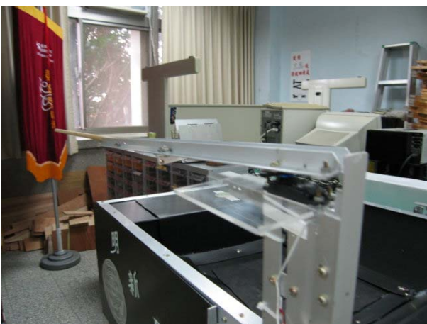
敲鑼機構：由鋁材搭配伺服機及圓形木材作為敲鑼機構。
