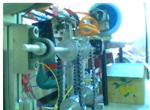
圖 4、皮帶輪機構與軸承
