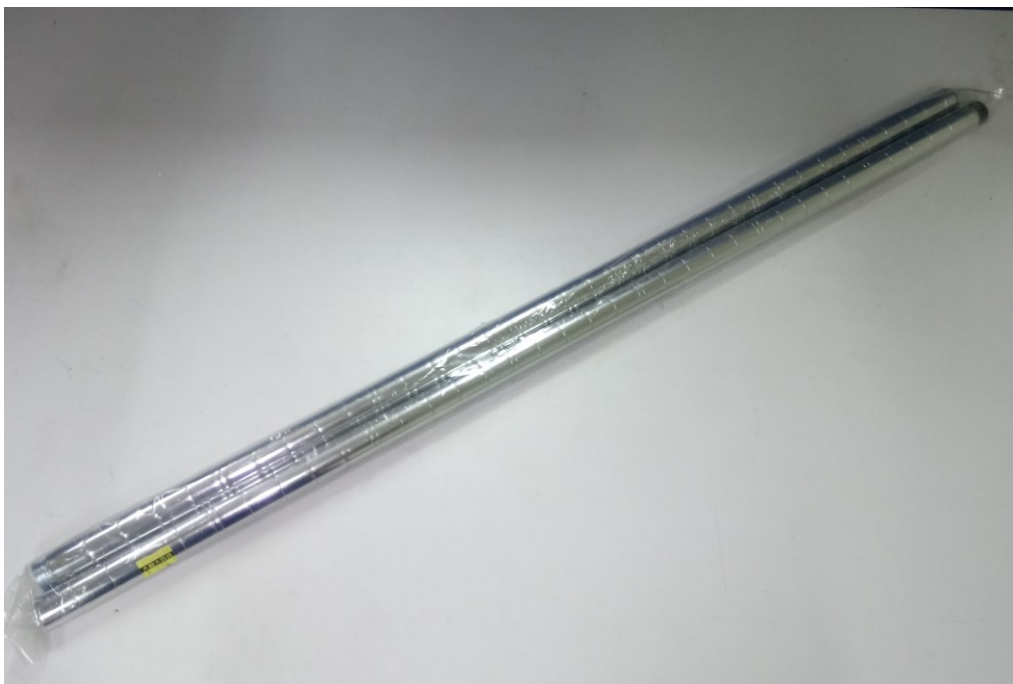
圖 4.9、組裝材料：鐵管 180CM 和 120CM，圓外徑為 25.52mm (以上尺寸誤差 \pm 20 mm，材料出自大盤大五金食品百貨賣場) 定位點規格說明如下：
