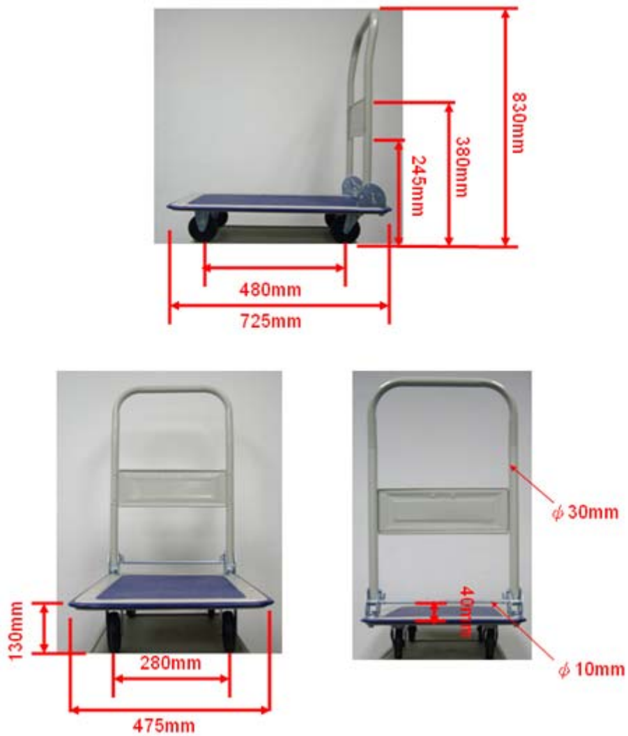
圖五、台車道具圖(手把下方兩輪為自由輪)，輪子尺寸為直徑 9.6cm 寬 2.2cm，台車重量約 8.06kg，精確尺寸以實物為憑
