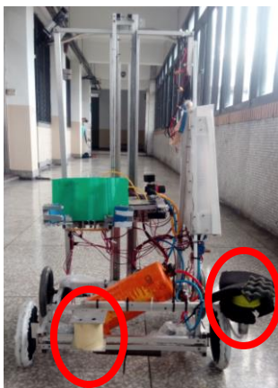
左圖：儲物小平台 右圖：開冰箱門機構
