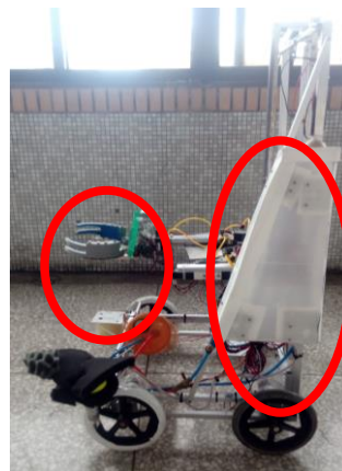
左圖：夾爪部分 右圖：所有電路
