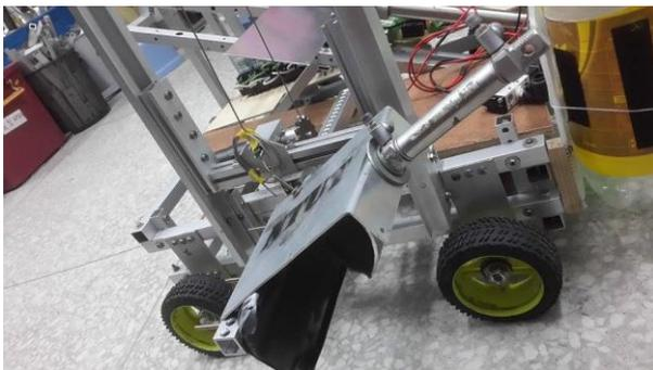
夾筆以固定邊為基準去對準筆，在下降機構並啟動氣壓缸去夾筆，放筆的話，以筆的重心來說是在偏後的位置，所以我們放筆不是用筆尖去對正，而是以筆的尾巴去抓取掉落位置。
