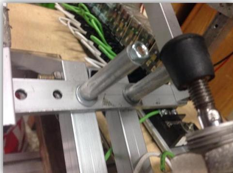
擊球只用一根氣壓缸來做推動，初期用過行程短的氣壓缸，擊出距離非常的短，發現氣壓跟行程是相輔相成的，因此改用行程較長的氣壓缸，再經由多次的測試選用最適當的氣壓&投射角度。
