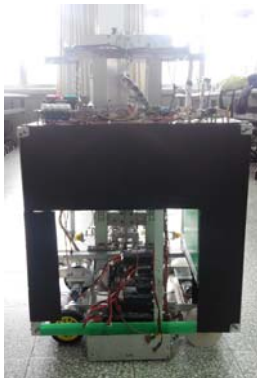
右側圖:電池裝置在右側，下方有重心平衡機構
