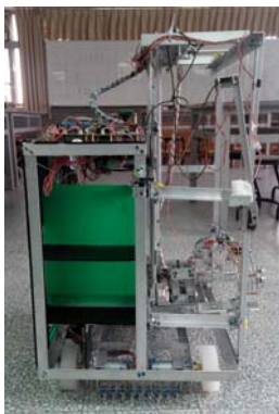
正視圖:車頭下方裝有紅外線感測器。
