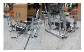
而夾持的桶子則是用止退環的概念來加裝於長筒,可 以達到抓取、防掉落與放置的效果,減少機構的設置增加 救援的時間,在搭配上則是上昇完成吊掛於覽車的動作, 下降完成夾取並且安置救援的動作。
