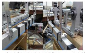
昇降手臂的部分則是設計為能夠吊掛兩公尺高的纜車 為基準,再以馬達來帶動輪藉由繩子作升高與下降的動 作,而吊掛籃的設置則配合上下的動作來完成一次性的動 作,夾住救援物與吊掛置纜車以及作回收的動作。
