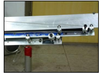
新式軸承滾輪 New bearing rollers
