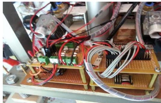
電路方面總共分成三個部分，我們的控制晶片是利基科技公司的 BC2，另外還有循跡感測器，RGB 三色感應器，馬達驅動器等等，而這些感測器都需要做經過整理將訊號送往控制晶片，於是我們有一塊電路板是再做訊號整理，另一塊電路板是給控制晶片，上面加裝了保險絲以免在撞擊時發生短路讓控制晶片損毀，再來就是電源供應電路，這一塊電路板裝了三種電源供應，有 5V、12V、24V，雖然我們的電池只用了兩種(12V、24V)但是循跡感測器和控制晶
