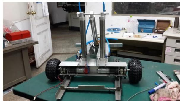
▲附圖 3，前端兩氣壓缸負責垂直上跳功能。
