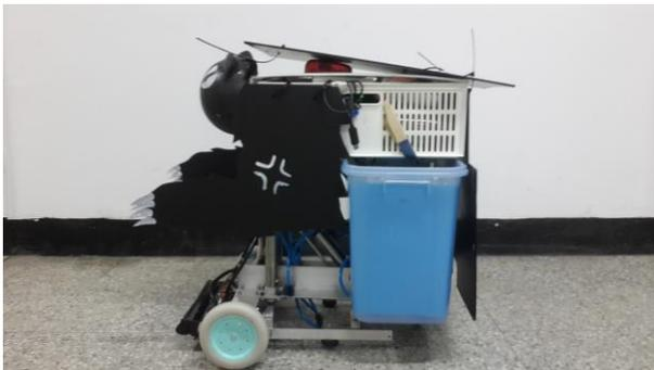
▲機器人左側視圖，藍色桶子內放置氣壓源(寶特瓶載)，中間部分隱約可見傾斜擺放之氣壓缸，底部構造也輕易可見，利用一底盤使氣壓送出時撞擊地面的接觸呈一面接觸而非點接觸，達到跳躍更穩定的效果。
