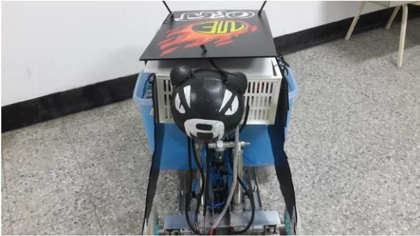
▲機器人前視圖，可明顯看到雙氣壓缸擺設垂直於地面及整體線路整理方式，中間白色提籃部分為電路放置區，前端下方則為馬達放置區。
