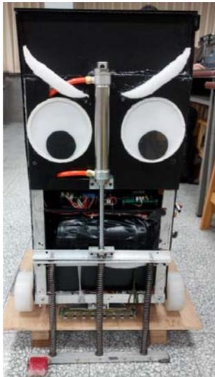
前方的彈跳機構，利用氣壓缸與彈簧的混合動力。
