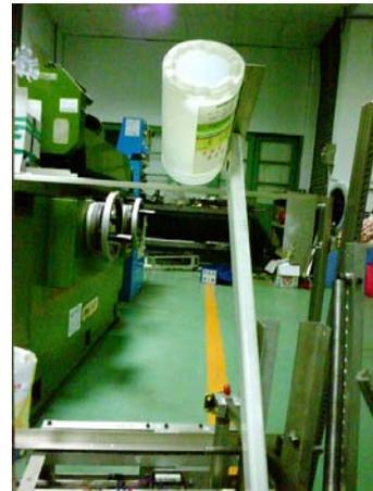
圖(14) 用塑膠瓶製作的取球筒
