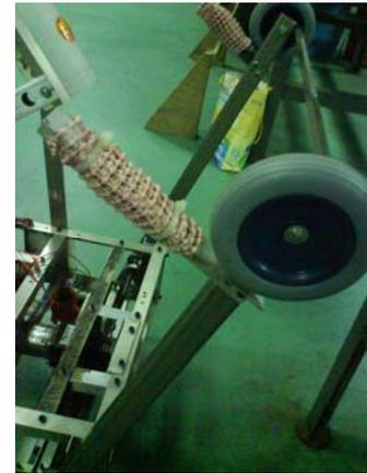
圖(13) 利用角鋁所製作的桿子，能將槓鈴放上
