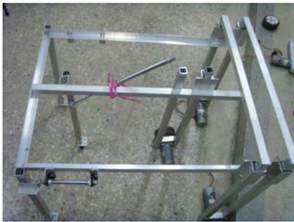
圖 3：底盤中央裝置的方鋁(增強結構和裝置其它機構用)
