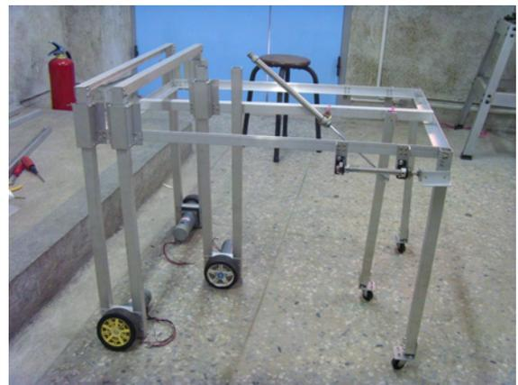
圖 1：尚未裝置其它機構的車子本體。(底盤與 4 組腳)
