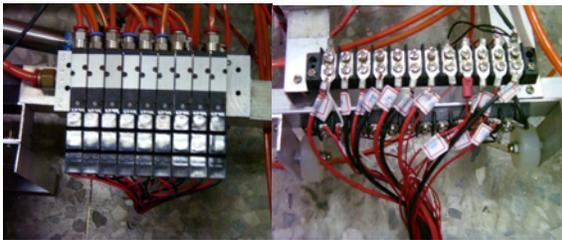
圖 10：電磁閥與端子台
