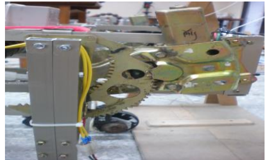
圖五 電動窗馬達
