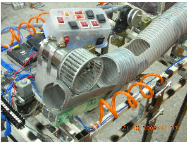
圖八：射球機構，球由右到左最後擠壓射出
