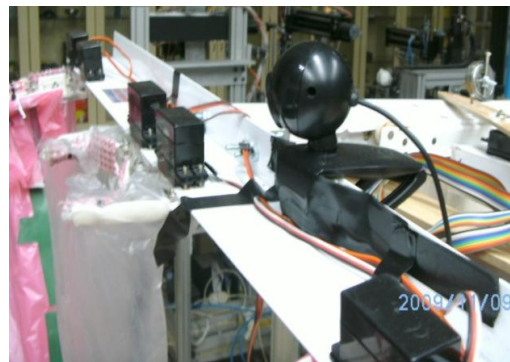
圖十四 顏色辨識系統之鏡頭
