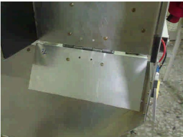
(下擋片放下時，物品隨之落下，在由下方導板修正物品絡下的位置。)
