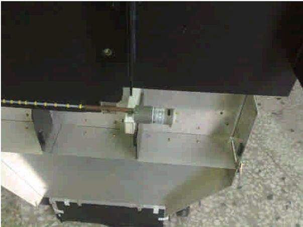
(物品回收擋片。搭配前端的馬達，可使回收擋片做 270 度的旋轉運動，讓機器人在待命區時可將回收擋片，以待命的方式出發。)
