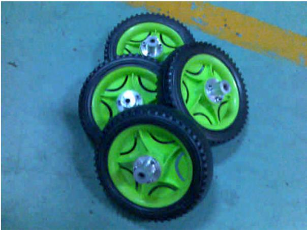
(4 英寸車輪與馬達軸套。)
