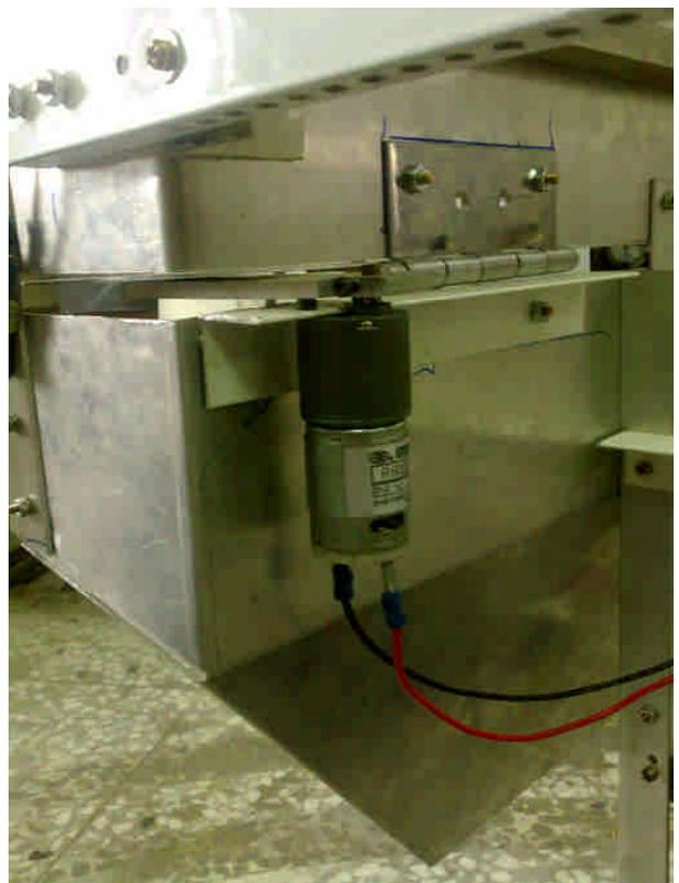
(回收物品放置機構。將固定平板鎖在馬達軸心上來固定下擋片；馬達旋轉之後，固定平板離開下擋片的位置，下擋片隨之落下。)
