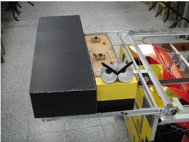
回收品拾取機構：由減速馬達及伺服機作為回收品拾取機構。
