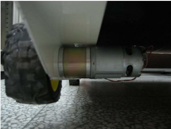
回收品拾取機構：由減速馬達及伺服機作為回收品拾取機構。
