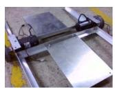
但夾爪伸長的長度加上龐大的車體可能會超出比賽限定,所以車體寬度改為 40cm,即車體改為長 80cm、寬 40cm、高 60cm。而伸長的夾爪所造成的力矩問題,就在延伸出去的水平內管上加一支輔助輪來解決。
