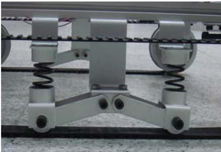
圖二 履帶中央裝置貼地適應緩衝機構
